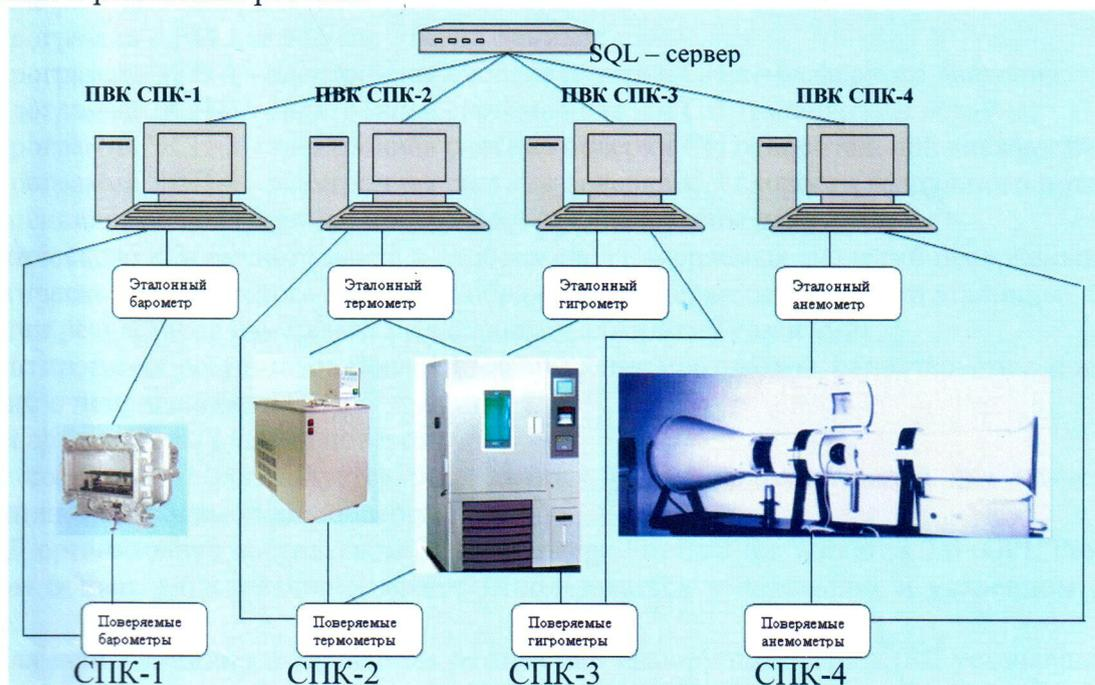
Рис. 1 Состав и общая схема СПЛ - 1
